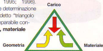
Figura 1 - Il triangolo della statica e le sue componenti.
